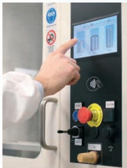
**SecurFill** è l'innovativo sistema marcato CE, completamente prodotto in Italia e brevettato dal **Gruppo SOL** per il riempimento automatico di contenitori di azoto liquido in estrema sicurezza ambientale, offrendo la possibilità di:
